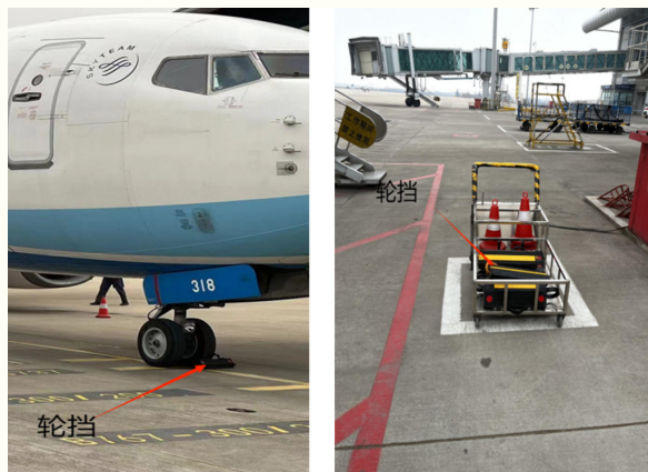
图 7 轮挡精确定位数据采集
