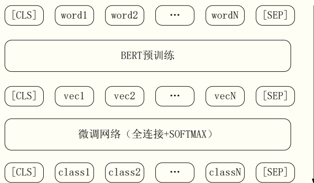
图1 命名实体识别网络结构示意图
